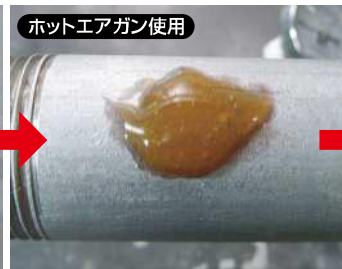
補修箇所を温め、塗布し10分程度熱されると金色に変色。 ※トーチ使用なら補修時間は短縮できます。
