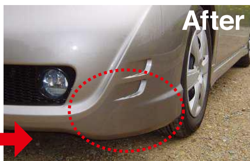
●表面は樹脂やパーツで仕上げ。●右ページのユニゾラーとの併用の補修例です。
